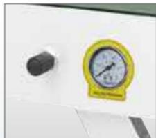
◀ 発泡ボードやアルミ複合板、多彩な板にも対応が出来る様に圧力調整メーターにて圧力調整が可能
