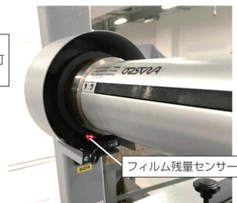
フィルムの最大・最小の直径を入力。最小になる前の警告時間3分~30分を入力。警告時間になると青ライトが点滅しオペレーターに知らせます。 ※工場出荷時のみ可能なオプション
