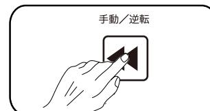
②詰まった紙を引き出してください。一度の操作で紙詰まりが解消しない場合は、“手動/正転”ボタンを押した後、再度“手動/逆転”ボタンを押して引き出してください。“手動/正転”“手動/逆転”を繰り返す場合はゆっくり行ってください。
