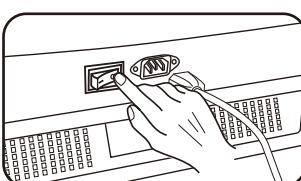
⑨ 電源プラグをコンセント(AC 100V)から抜き、アース端子を取り外してください。
