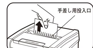
③ 一度の操作で紙詰まりが解消しない場合は、手動/正転ボタンを押した後に、再度手動/逆転ボタンを押してください。
