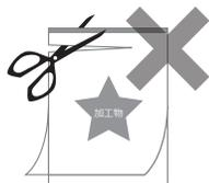
ラミネート加工は必ずシール部(接合部)から挿入する必要があるため、切り取ったフィルムを加工すると、本体内でフィルムがずれてしまい、詰まりの原因となります。
