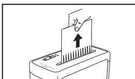
4 紙を引き出したら詰まった紙の量を減らして、細断していない方向から投入口にまっすぐに入れ細断してください。
