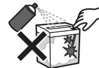
シュレッダの紙投入口、カッター部、ダストボックス等にスプレー噴霧した場合、シュレッダ内部に可燃性ガスが滞留し、シュレッダのON-OFFスイッチの切り替え接点の火花、静電気の火花、内部モーター整流子の火花等に引火して、火災や爆発を引き起こす恐れがあります。機械の清掃や機構部の注油が必要な場合は、取扱説明書をご覧になるか、弊社にお問い合わせの上、危険のない正しいやり方で行ってください。(万一事故が発生し火傷を負った場合は、すぐに患部を氷水等で冷やしてから医師の手当てを出来るだけ早く受けてください)
