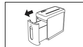
4 ゴミを捨てた後、インターロックトリガーがインターロックスイッチを押し込むようにしっかりとセットしてください。
