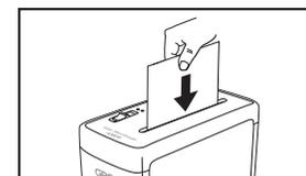
**3** カードは必ず一枚ずつ、オートスタートセンサーを通過するように投入してください。
