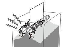
細断くずがダストボックスの窓の7割付近まで溜まいたら、早めに細断くずを捨ててください。紙詰まりを起こし、故障の原因となります。
