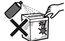
シュレッダの紙投入口、カッター部、ダストボックス等にスプレー噴霧した場合、シュレッダ内部に可燃性ガスが滞留し、シュレッダのON-OFFスイッチの切り替え接点の火花、静電気の火花、内部モーター整流子の火花等に引火して、火災や爆発を引き起こす恐れがあります。機械の清掃や機構部の注油が必要な場合は、取扱説明書をご覧になるか、弊社にお問い合わせの上、危険のない正しいやり方で行ってください。(万一事故が発生し火傷を負った場合は、すぐに患部を氷水等で冷やしてから医師の手当てを出来るだけ早く受けてください)
