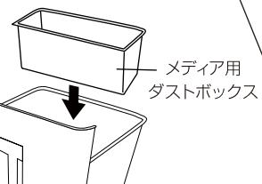
メディア用ダストボックスのツメを、ダストボックスのふちにある溝に取り付けてご使用ください。
