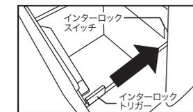
※ダストボックスが正しくセットされていない場合は、安全のために本機は作動しません。インターロックスイッチ/トリガーを破損しないように、ていねいにお取り扱いください。
