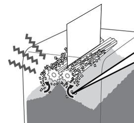
細断くずが巻き上がるとカッターが目詰まりし、故障の原因になります。
