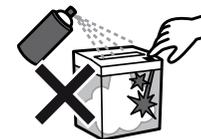
シュレツダの紙投入口、カッター部、ダストボックス等にスプレー噴霧した場合、シュレツダ内部に可燃性ガスが滞留し、シュレツダのON-OFFスイッチの切り替え接点の火花、静電気の火花、内部モーター整流子の火花等に引火して、火災や爆発を引き起こす恐れがあります。
