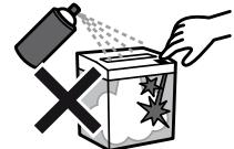
シュレッダの紙投入口、カッター部、ダストボックス等にスプレー噴霧した場合、シュレッダ内部に可燃性ガスが滞留し、シュレッダのON-OFFスイッチの切り替え接点の火花、静電気の火花、内部モーター整流子の火花等に引火して、火災や爆発を引き起こす恐れがあります。
