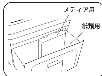
※ゴミ捨て時に、インターロックスイッチ/トリガーを破損しないようにていねいにお取り扱いください。
